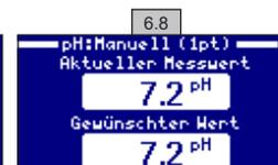
**6.8** Ohne die Sonde aus dem Wasser zu nehmen, korrigieren Sie mit den Pfeiltasten MEHR/ WENIGER den angezeigten Messwert, bis er mit dem Referenzwert übereinstimmt (Fotometer oder anderes Messgerät).
