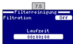
**7.5 Modus Reinigung des Filters** (und Reinigung des Pools durch Absaugung): Dieses Menü (von jedem beliebigen Filtermodus aus zugänglich) dient dazu, eine Rückspülung des Sandfilters durchzuführen. Die Aktivierung dieses Menüs von jedem beliebigen Filtermodus aus (Manuell, Automatik, Smart) bewirkt, dass die Elektrolyse-/Hydrolysezelle getrennt wird. Gehen Sie anschließend wie folgt vor:
