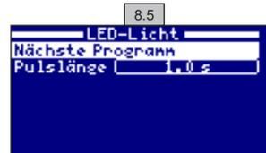
**8.5 Farbwahl:** Mit diesem Menü können Sie die Scheinwerferfarben Ihres Pools ändern. Die Option *Nächstes Programm* dient dazu, den Farbwechsel manuell zu programmieren, und mit der Option *Impulslänge* wählen Sie die Frequenz der Farbwechsel.
