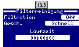
**13.5 Filterreinigung:** Für die Reinigung eines Filters mit einer Pumpe mit variabler Geschwindigkeit müssen Sie die höchste Geschwindigkeit wählen.
